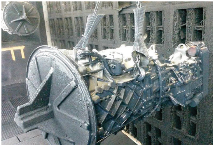
Aufgrund der komplexen Geometrien werden die Getriebe nach der automatischen Applikation an wenigen Stellen manuell von Hand beschichtet. Quelle (drei Bilder): ZF Friedrichshafen AG
